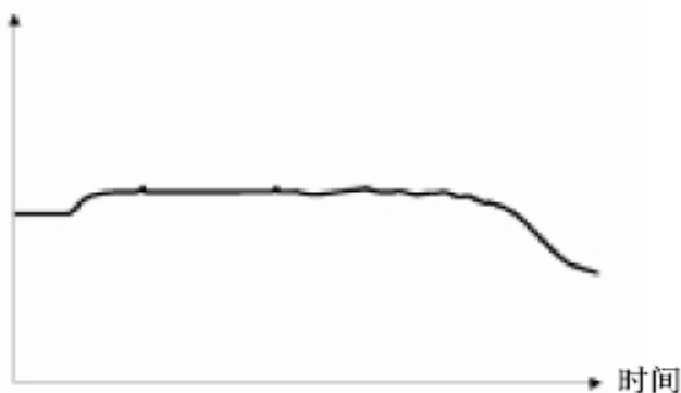
图 5.3.2 用变化率限制技术消除粗大误差噪声
